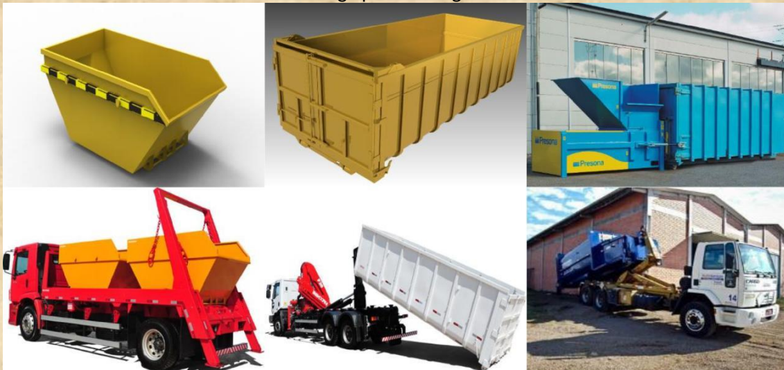
Figura 90. Exemplo de acondicionadores e veículos de transporte para rejeitos segregados em galpão de triagem.
